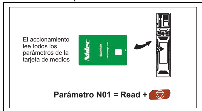
Figura 4-3 Inicio y almacenamiento automático del accionamiento para ascensores con la tarjeta de medios NV SMARTCARD
